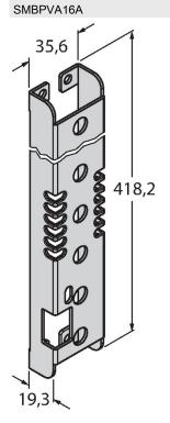
3062449 Montagehalterung, für PVA375, kaltgewalzter Stahl, Aussparung für DIP-Schalter-Bank, Schutz für Leuchtanzeige
