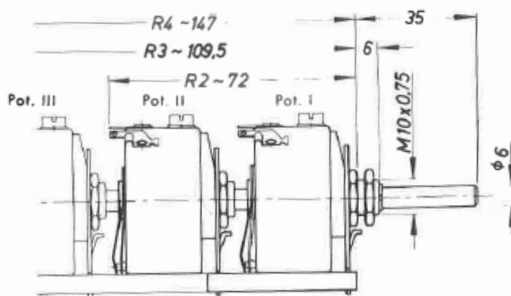
Die Befestigung der kompletten Anordnung erfolgt wie bei der Normalausführung durch Einlochmontage. Die Drehwidestände sind elektrisch vollkommen getrennt, die Schleifer sind isoliert auf gemeinsamer Welle angeordnet. Drehwiderstand I beim Drehknopf. Alle weiteren Einzelheiten siehe Normalausführung.
