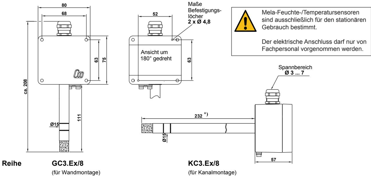
\*) Sondertyp mit 290 mm langem Sensorrohr auf Anfrage
