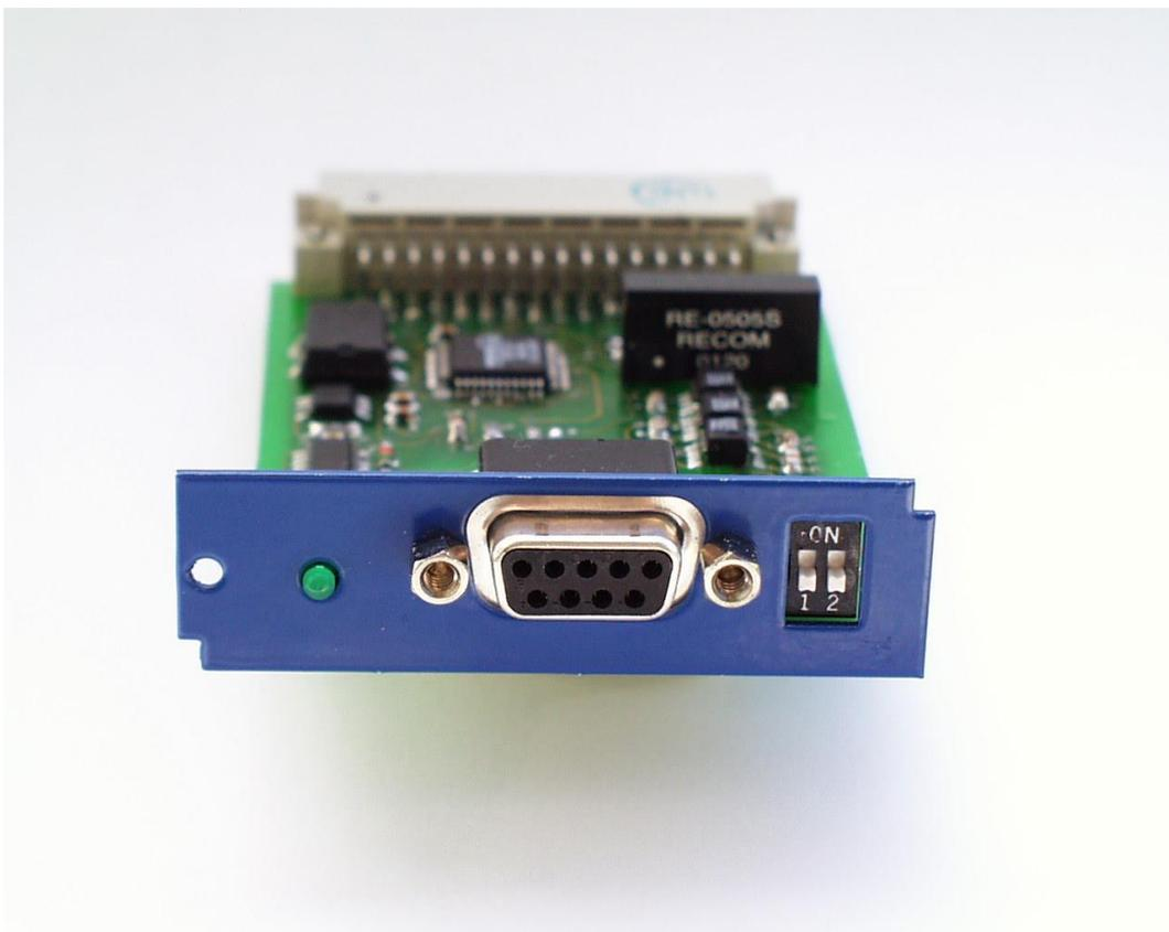
**Figure 33: PROFIBUS-DP interface: Front view**
