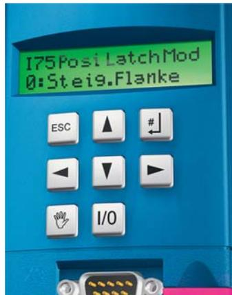
Display und Tastatur sind integriert. Schnelle Diagnose, Statusüberwachung, direkter Parameterzugriff und Handfahrfunktionen sind damit möglich.
