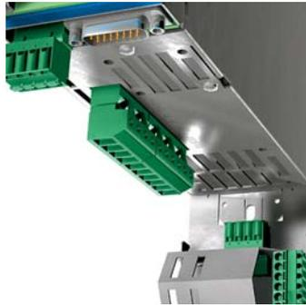
An der Gehäuseunterseite befinden sich die getrennten Anschlüsse für Motor, Zwischenkreis und Bremswiderstand. Dort werden auch mit einfacher Steckmontage Kaltleiter und Bremsrelais kontaktiert.
