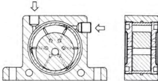
Die Luftzufuhr erfolgt über eine von zwei Einlassöffnungen, welche rechtwinklig zueinander in den Korpus gebohrt sind. Diese Einlassöffnungen sind mit einem Standardrohrgewinde versehen. Ein Verschlusszapfen wird mitgeliefert, um die nicht benutzte Leitung zu verschließen. Der Luftausstoß erfolgt über die speziellen Kunststoffendplatten, in welche ein Schalldämpfer eingebaut wurde.
