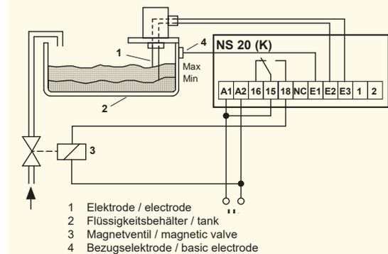
Zulaufsteuerung mit 2 Elektroden (E3 benetzt, Relais aus 15-16 geschlossen)
