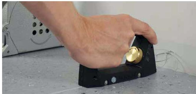
Der neue Handfugenhobel «Groovy» eignet sich auch perfekt für Fugenabschlüsse bei Fussböden.
