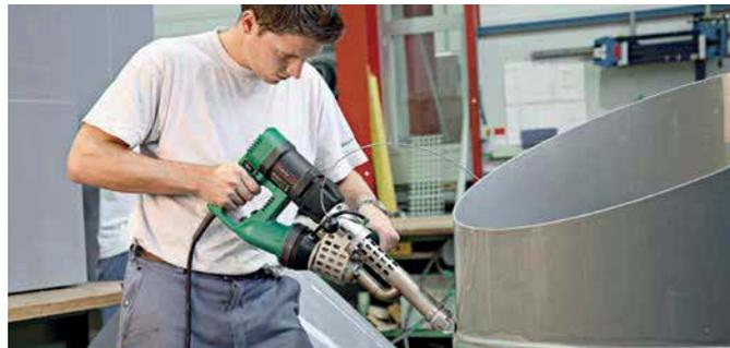
FUSION 3C beim Schweißen einer V-Naht.
