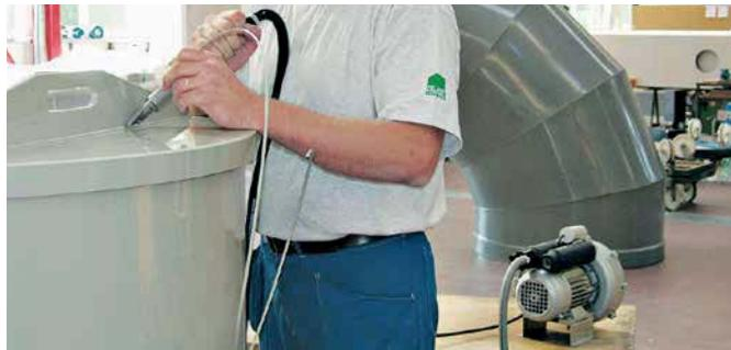
Gebläse ROBUST als Luftversorgung für den WELDING PEN.
