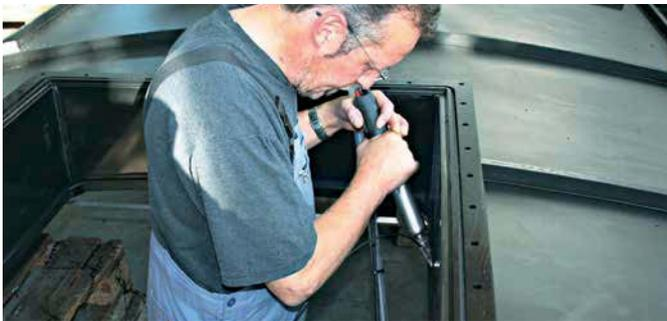
DIODE PID beim Ziehschweissen an einem PE-Behälter.
