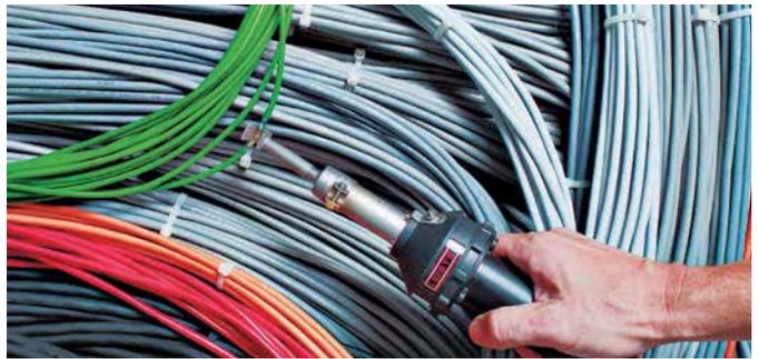
Anbringen einer Lötshrumpfverbindung mit dem HOT JET S und aufgeschobenem Siebreflektor.
